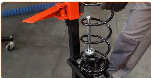
**45** Paigaldage tolmutate ja uue amortisaatori stopper.
