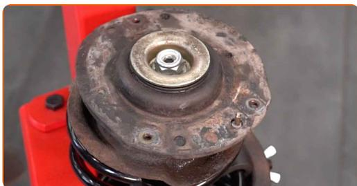
**47** Paigaldage ülemine vedrupüstak ja vedrupüstaku laager.
