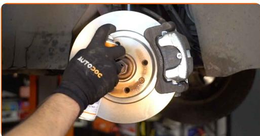
**30** Puhastage piduriketta pind. Kasutage piduri puhastusvahendit.
