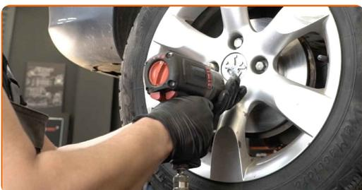
42 Laske auto alla ja töödake risti järjekorras, pingutage rataste poldid. Kasutage ratta löökpadrunit #17. Kasutage momentvõtit. Pingutage seda 100 Nm pöördemomendiga.
