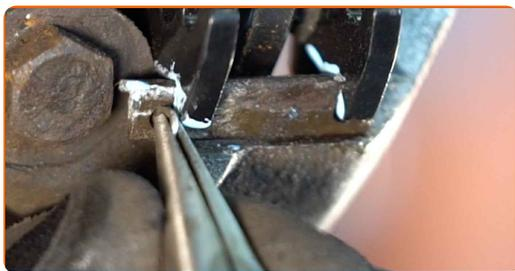
**16** Paigaldage piduriklotside hoivedrud.
