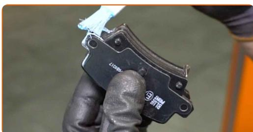
**20** Paigaldage uued piduriklotsid.
