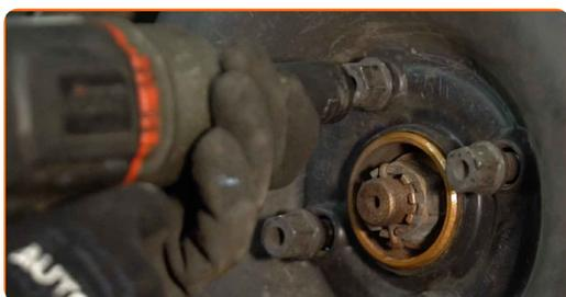
**40** Laske auto alla ja töödake risti järjekorras, pingutage rataste poldid. Kasutage ratta löökpadrunit #17. Kasutage momentvõtit. Pingutage seda 110 Nm pöördemomendiga.
