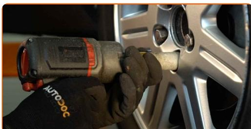
**58** Laske auto alla ja töödake risti järjekorras, pingutage rataste poldid. Kasutage ratta löökpadrunit #19. Kasutage momentvõtit. Pingutage seda 108 Nm pöördemomendiga.
