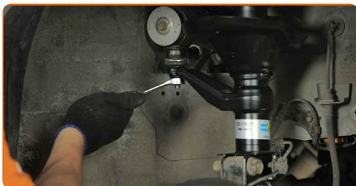
**52** Paigaldage splint. Kasutage näpitstange.
