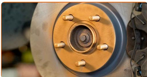
**55** Puhastage piduriketta pind. Kasutage piduri puhastusvahendit.
