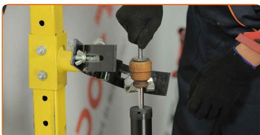
**26** Paigaldage amortisaatori vedru. Paigaldage ülemine vedrupüstak ja vedrupüstaku laager.
