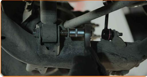
**9** Eemaldage alumine amordipüstaku osa. Kasutage sõrgkangi.
