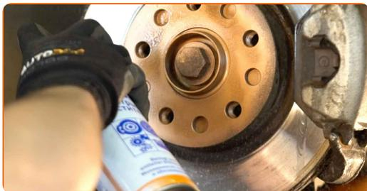
**23** Puhastage piduriketta pind. Kasutage piduri puhastusvahendit.
