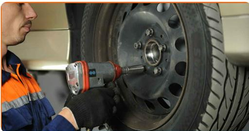
28 Laske auto alla ja töödake risti järjekorras, pingutage rataste poldid. Kasutage ratta löökpadrunit #17. Kasutage momentvõtit. Pingutage seda 120 Nm pöördemomendiga.
