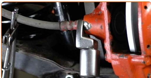
**46** Paigaldage piduriklotsid.
