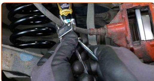
**14** Puhastage pidurivooliku paigalduspesa pidurisadulal. Kasutage terasharja. Kasutage WD-40 aerosooli.
