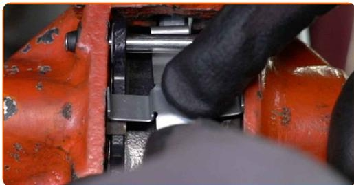
**48** Paigaldage piduriklotsi juhttihvrid. Kasutage torni. Kasutage haamrit.
