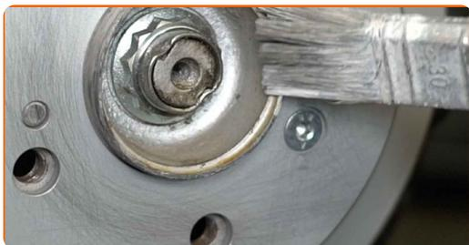
**57** Puhastage piduriketta pind. Kasutage piduri puhastusvahendit.
