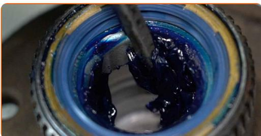
**32** Taaspaigaldage rattarumm koos uute laagritega.
