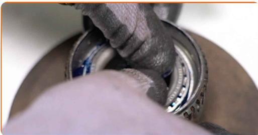
**30** Paigaldage rattalaagri kaelustihend. Kasutage pukside ja laagrite vahetamiskomplekti.
