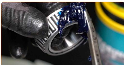
**29** Paigaldage laagrite osad uuesti rattarummu.
