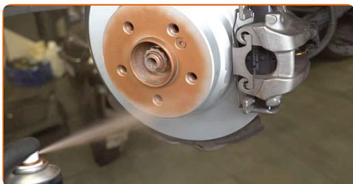
29 Puhastage piduriketta pind. Kasutage piduri puhastusvahendit.
