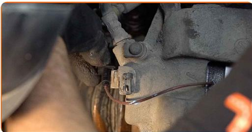
**30** Puhastage piduriketta pind. Kasutage piduri puhastusvahendit.
