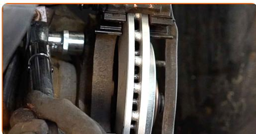
**25** Paigaldage piduriklotsid.
