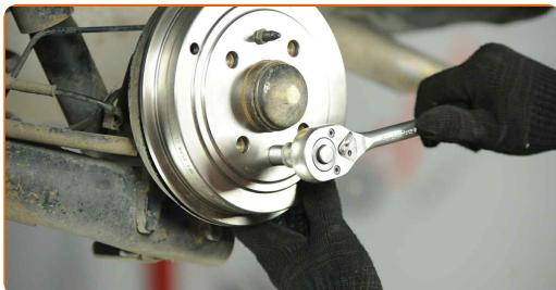
**32** Puhastage rattatervelgede kinnituspesad. Kasutage terasharja. Töödelge pindasid, kus velg puutub piduritrumliga kokku. Kasutage vasemääret.
