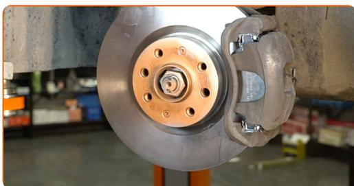
**21** Puhastage piduriketta pind. Kasutage piduri puhastusvahendit.
