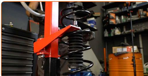
**46** Paigaldage ülemine vedrupüstak ja vedrupüstaku laager.
