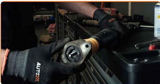
**19** Pingutage amortisaatorivarda mutrit. Kasutage kombivõtit Nr.13. Kasutage amortisaatori padrunit Nr. DD6. Kasutage momentvõtit. Pingutage seda 25 Nm pöördemomendiga.
