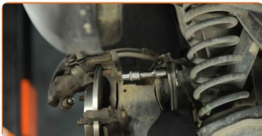
**25** Paigaldage piduriklotsid.
