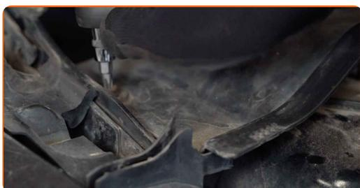
**10** Eemaldage alumine plastikust tuuleklaasi õhutusvõre.
