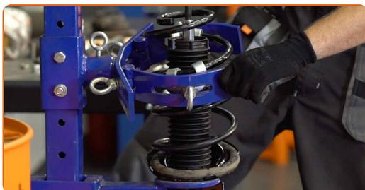
**38** Paigaldage ülemine vedrupüstak ja vedrupüstaku laager.
