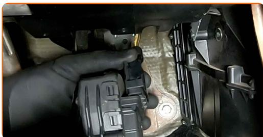
**14** Paigaldage gaasipedaal.
