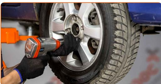
48 Laske auto alla ja töödake risti järjekorras, pingutage rataste poldid. Kasutage ratta löökpadrunit #19. Kasutage momentvõtit. Pingutage seda 95 Nm pöördemomendiga.
