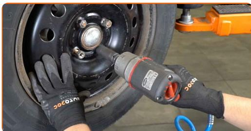
**34** Laske auto alla ja töödake risti järjekorras, pingutage rataste poldid. Kasutage ratta löökpadrunit #19. Kasutage momentvõtit. Pingutage seda 110 Nm pöördemomendiga.
