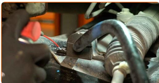
**17** Puhastage pöikstabilisaatori pukside paigaldusasemed. Kasutage terasharja. Kasutage universaalset puhastusspreid.
