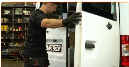
2 Eemaldage tagumise vasaku ukse sisemine ehispaneel. Kasutage klambrite eemaldamise tööriista.
