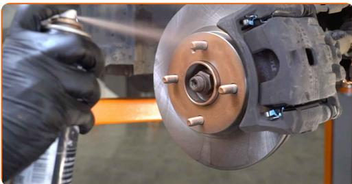
**27** Puhastage piduriketta pind. Kasutage piduri puhastusvahendit.
