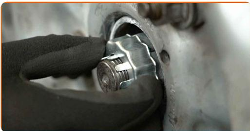
**91** Paigaldage splint. Kasutage heebliit.
