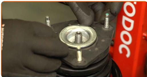
**64** Paigaldage ja pinguldage amortisaatori kolvivarda mutrit. Kasutage 18 mm amortisaatori mutri padrunit. Kasutage H6 kuuskandi pikendust. Kasutage momendimõõtevõtit. Pingutusmoment: 70 N·m.
