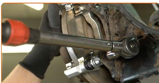
**25** Paigaldage piduriklotsid.
