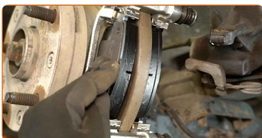
**26** Paigaldage sisemisele piduriklotsile kulumisandur.
