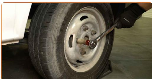
**35** Eemaldage tungraud, aluspukid ja rattaklotsid.
