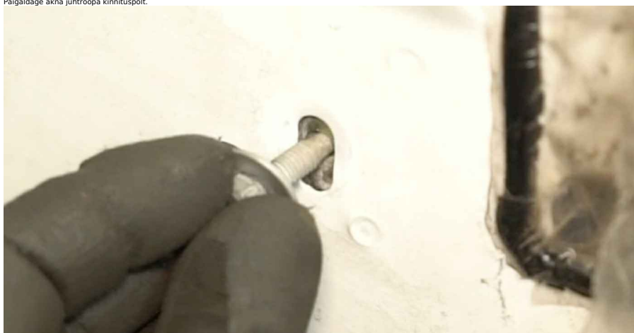
25 Pingutage akna juhtroopa kinnitit. Kasutage 8 mm padrunit. Kasutage momendimõõtevõtit. Pingutusmoment: 6 N·m.
