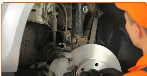
**41** Pingutage alumisi amordipüstaku ja käändtelje vahelisi kinnitusi. Kasutage kombivõtit Nr. 18. Kasutage padrunit Nr.18. Kasutage momentvõtit. Pingutage seda 85 Nm pöördemomendiga.+90°
