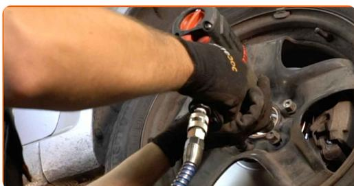
46 Laske auto alla ja töödake risti järjekorras, pingutage rataste poldid. Kasutage ratta löökpadrunit #17. Kasutage momentvõtit. Pingutage seda 110 Nm pöördemomendiga.
