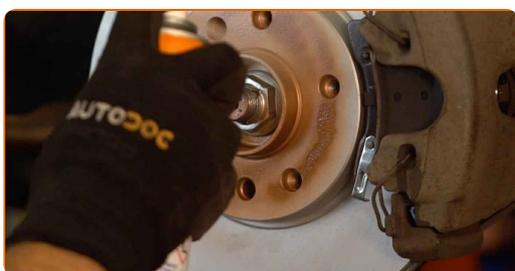
43 Puhastage piduriketta pind. Kasutage piduri puhastusvahendit.
