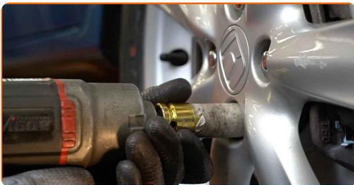
**22** Laske auto alla ja töödake risti järjekorras, pingutage rataste poldid. Kasutage ratta löökpadrunit #19. Kasutage momentvõtit. Pingutage seda 108 Nm pöördemomendiga.
