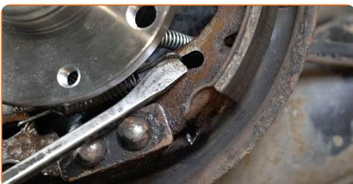
**16** Eemaldage piduriklotside survetihvtid. Kasutage ümara otsaga tange.
