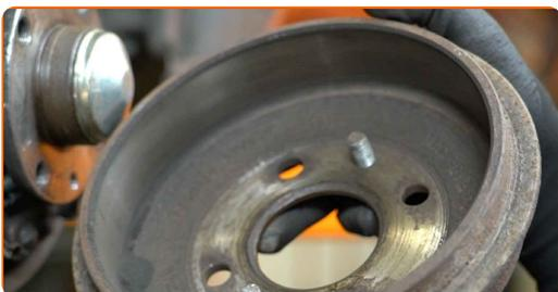
**14** Puhastage piduriklotside kinnitused. Kasutage terasharja. Kasutage WD-40 aerosooli.
