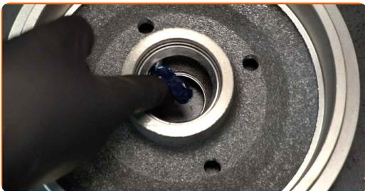
**22** Paigaldage uus rummu laager ja kinnitage see.
