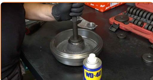
**19** Puhastage rummu laagri kinnituspesa. Kasutage WD-40 aerosooli.
