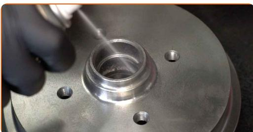
**20** Paigutage rattarummu uue laagrivõru piduritrumlisse. Kasutage pukside ja laagrite vahetamiskomplekt. Kasutage haamrit.
