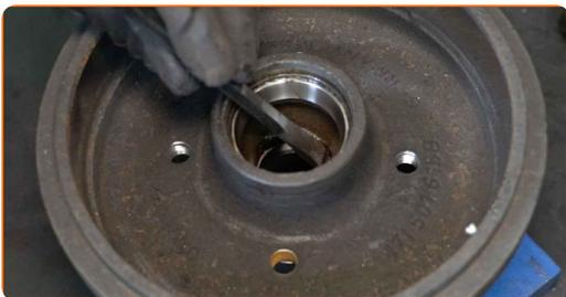
**16** Eemaldage rattarummu laagrivõru piduritrumlist. Kasutage lapikut metallitöö meislit. Kasutage haamrit.
