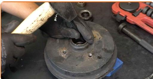
**17** Puhastage rummu laagri kinnituspesa. Kasutage WD-40 aerosooli.
