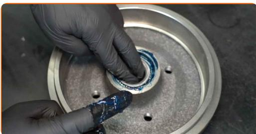
**23** Paigaldage rattarummu laagri hoiderõngas. Kasutage pukside ja laagrite vahetamiskomplekt. Kasutage haamrit.
