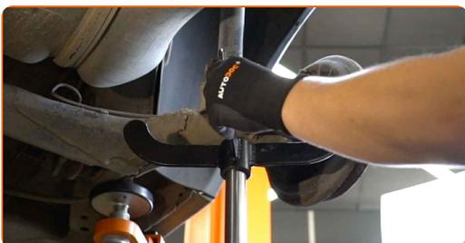
**14** Keerake lahti amortisaatori survevarda alumine kinnitus. Kasutage kombivõtit Nr. 17. Kasutage padrunit Nr.17. Kasutage toruvõtit.
