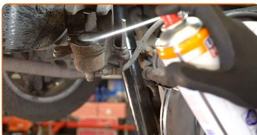
Vahetamine: piduriklotside – INFINITI FX. AUTODOC'i eksperdid soovitavad:
