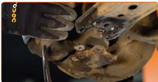
**18** Keerake lahti alumine kinnitus, mis ühendab amordipüstakut käändteljega. Kasutage padrunit Nr.18. Kasutage kärstivõtit. Kasutage toruvõtit.
