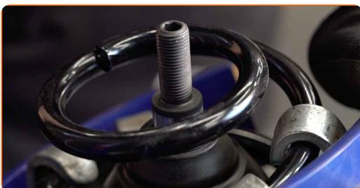
**38** Paigaldage ülemine vedrupüstak ja vedrupüstaku laager.
