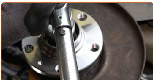
**32** Paigaldage rummulaagrite kaas. Kasutage kummihaamrit.
