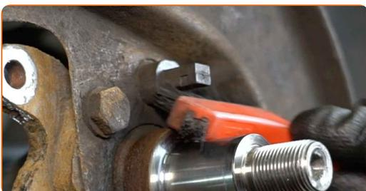
**29** Paigaldage uus rattarumm koos laagriga. Kasutage pukside ja laagrite vahetamiskomplekti. Kasutage haamrit.
