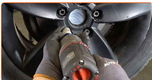
49 Laske auto alla ja töödake risti järjekorras, pingutage rataste poldid. Kasutage ratta löökpadrunit #17. Kasutage momentvõtit. Pingutage seda 120 Nm pöördemomendiga.
