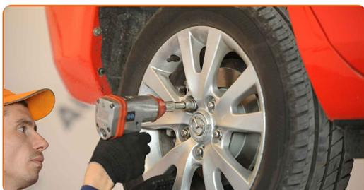
**32** Laske auto alla ja töödake risti järjekorras, pingutage rataste poldid. Kasutage ratta löökpadrunit #19. Kasutage momentvõtit. Pingutage seda 118 Nm pöördemomendiga.
