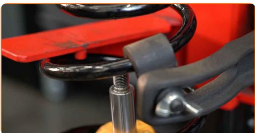
**33** Paigaldage ülemine vedrupüstak ja vedrupüstaku laager.
