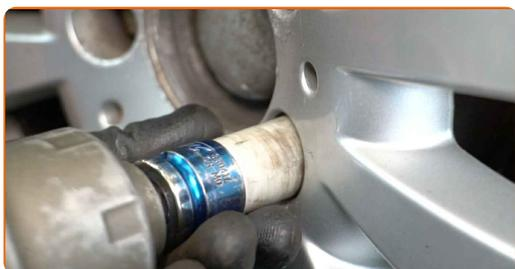
**20** Laske auto alla ja töödake risti järjekorras, pingutage rataste poldid. Kasutage ratta löökpadrunit #17. Kasutage momentvõtit. Pingutage seda 130 Nm pöördemomendiga.
