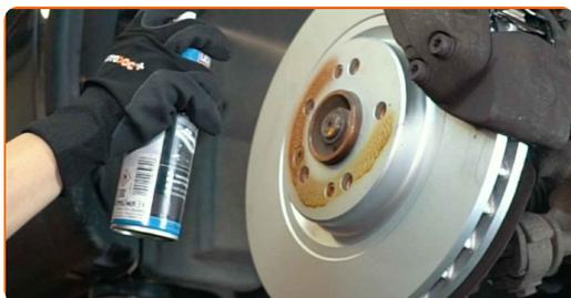
**20** Puhastage piduriketta pind. Kasutage piduri puhastusvahendit.
