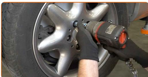
22 Laske auto alla ja töödake risti järjekorras, pingutage rataste poldid. Kasutage ratta löökpadrunit #17. Kasutage momentvõtit. Pingutage seda 110 Nm pöördemomendiga.
