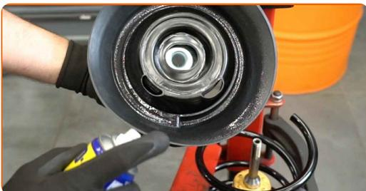
**39** Paigaldage ülemine vedrupüstak ja vedrupüstaku laager.
