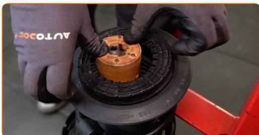
**35** Paigaldage ülemine vedrupüstak ja vedrupüstaku laager.
