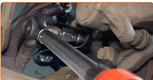
**47** Pingutage alumisi amordipüstaku ja käändtelje vahelisi kinnitusi. Kasutage tähikvõtit E14. Kasutage momentvõtit. Pingutage seda 100 Nm pöördemomendiga.
