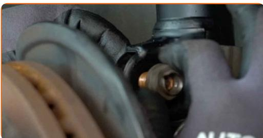
**46** Pingutage alumisi amordipüstaku ja käändtelje vahelisi kinnitusi. Kasutage padrunit Nr.21. Kasutage tähikvõtit E18. Kasutage momentvõtit. Pingutage seda 100 Nm pöördemomendiga.+90°
