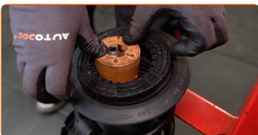
**33** Paigaldage ülemine vedrupüstak ja vedrupüstaku laager.
