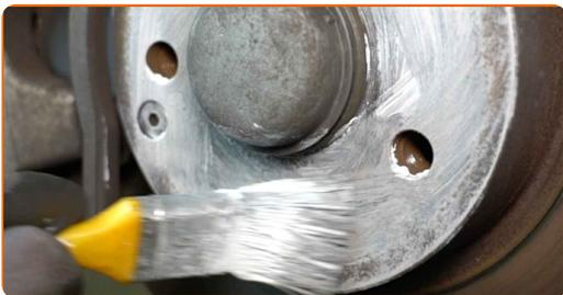
**53** Puhastage piduriketta pind. Kasutage piduri puhastusvahendit.
