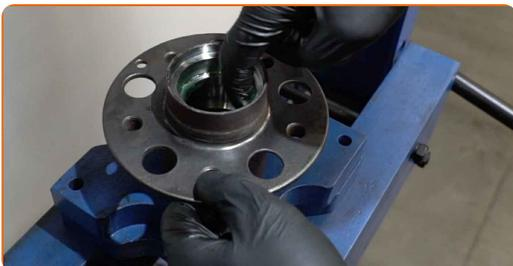
**36** Paigutage rattalaagri sisevõru rummu. Kasutage pukside ja laagrite vahetamiskomplekti.
