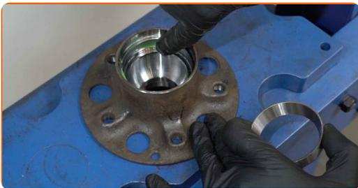
**34** Paigutage rattalaagri sisevõru rummu. Kasutage pukside ja laagrite vahetamiskomplekti.
