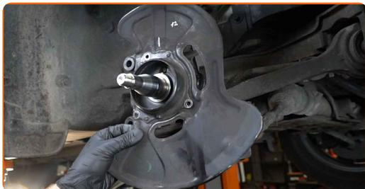
**47** Keerake piduriketta katte kinnitused kinni. Kasutage padrunit Nr.E12. Kasutage momentvõtit. Pingutage seda 11 Nm pöördemomendiga.
