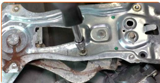
**30** Eemaldage elektrilise klaasitõstuki mootor.
