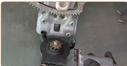
**31** Paigaldage ja keerake kinni uue klaasitõstukimehhanismi mootori kinnitused. Kasutage tähikvõtit T30. Kasutage kärstivõtit.
