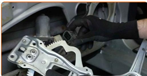
**33** Paigaldage uus aknatõstuki mehhanism.
