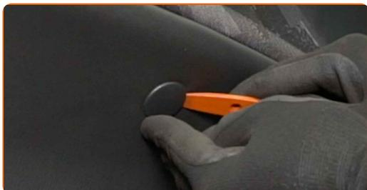
**6** Eemaldage ukseingi iluliist. Kasutage plastikust eemaldajat.
